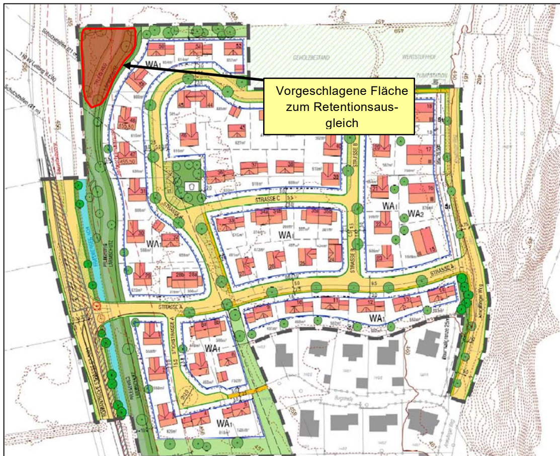
Abb. 9: Fläche zur Geländeabsenkung für den Retentionsausgleich; Dr. Blasy & Dr. Øverland Beratende Ingenieure GmbH & Co. KG
